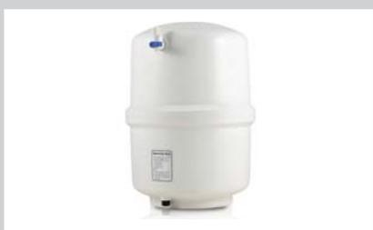
Pressione di Stop (default  $\approx$  4 bar)Pressione di Start (default  $\approx$  2 bar)Pressione di precarica aria (default  $\approx$  1.8 bar)
